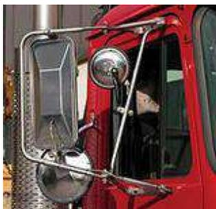
7.1. Количество, расположение и класс зеркал заднего вида не соответствуют ГОСТу Р 51709-2001, отсутствуют стекла, предусмотренные конструкцией транспортного средства.
